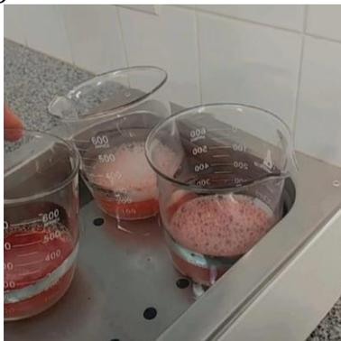
5. Após a etapa de banho-maria, a solução foi retirada e imediatamente colocada em uma caixa de isopor com gelo, onde permaneceu por 5 minutos (Figura 4).
