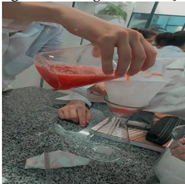
7. O filtrado foi transferido para um béquer de vidro com capacidade de aproximadamente 250ml, considerando a quantidade obtida após a filtração.
