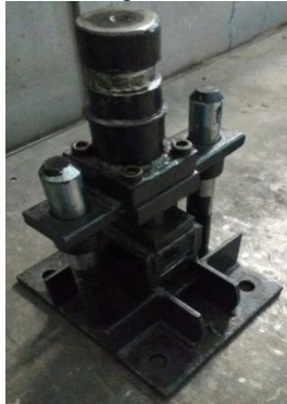
Figura 6 — Prensa hidráulica com gabarito mal regulado
