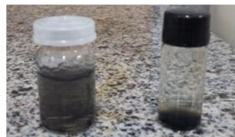
Figura 2: Dispersão em banho ultrassônico, NG à esquerda e grafite natural à direita.
