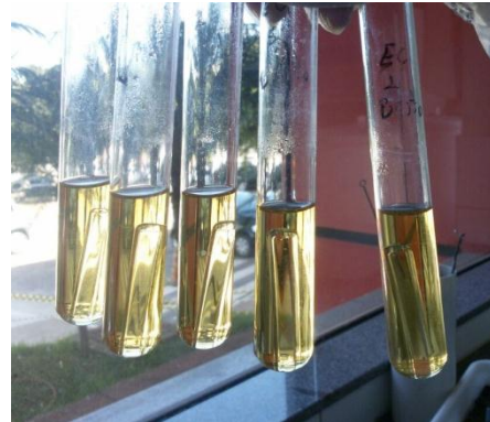
Figura 4: coliformes totais e termotolerantes/mL presentes no efluente filtrado.
