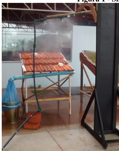
1.a - Simulação no telhado convencional
