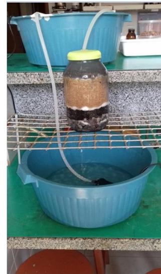
Figura 2: Filtro em funcionamento.
