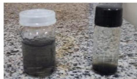
amostras em meio surfactante, após o banho de ultrassom. A amostra 1 que está à esquerda contém as NG e a amostra 2, grafite natural, ambas em meio surfactante à mesma concentração. Nota-se que a amostra 1 apresentou uma eficiente dispersão, devido a sua leveza, homogeneidade e baixa densidade, comprovando assim a formação das NG. Já a amostra 2, os flocos de grafite permaneceram inertes no fundo do vidro, ficando evidente a diferença entre as duas amostras.
